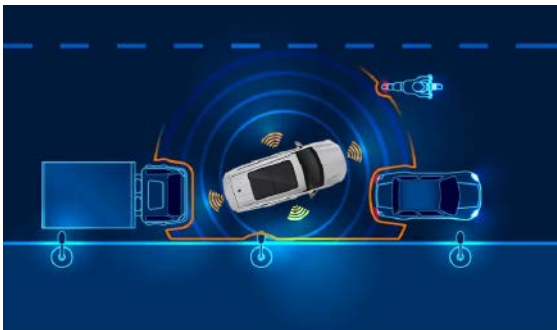
Advertencia de colisión trasera (RCW). Si un vehículo se acerca rápidamente, el sistema permite tomar medidas evasivas o, en caso más grave, prepararse para el impacto.
