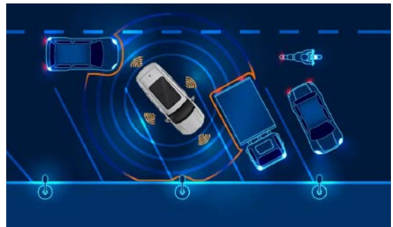
Alerta de tráfico cruzado (RTCA). Sistema de seguridad que detecta vehículos que se aproximan lateralmente cuando se está retrocediendo, como al salir de un estacionamiento.
