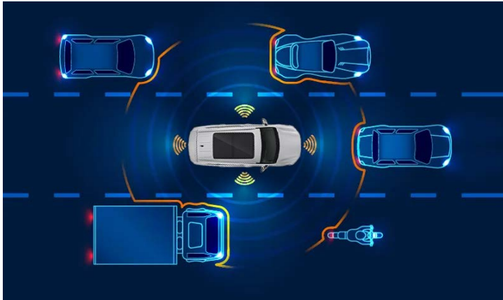
Asistente de cambio de carril. Monitorea los vehículos en los carriles adyacentes, alertando al conductor sobre posibles peligros al cambiar de carril.
